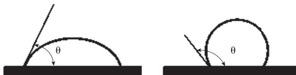
图1 接触角示意图
